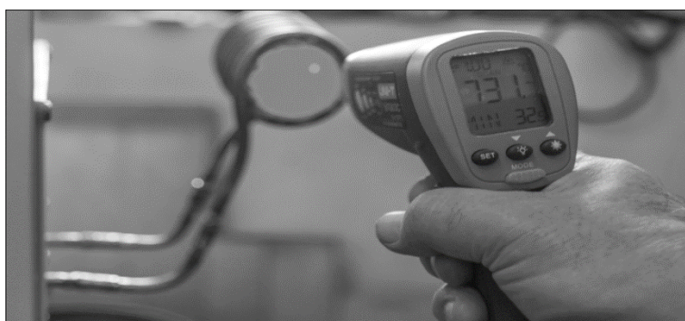
Рис. 3. Процесс индукционного нагрева металла до температуры 731 0 С
