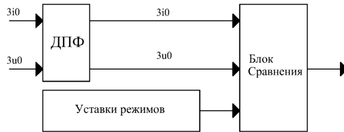
Рис. 11. Структурно-функциональная схема пускового органа защиты на основе токов и напряжений нулевой последовательности
