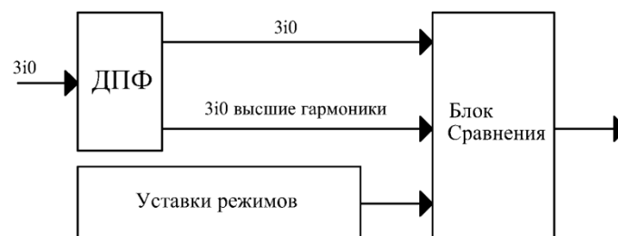
Рис. 7. Упрощенная структурно-функциональная схема пускового органа защиты на основе токов гармоник.
