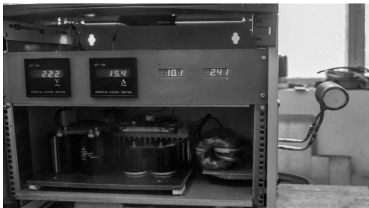
Рис. 2. Индукционный нагреватель в период испытания
